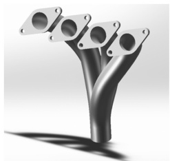
图 1 排气歧管三维模型
