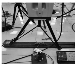
图4 PCB基板约束安装图 图5 PCB基板约束模态试验测试安装图
