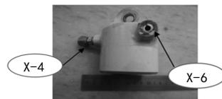
图 2 接管嘴 X-6 断裂图
