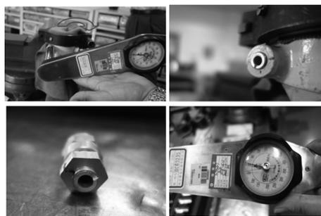
图 12 旧件接管嘴 X-6 拧断现场操作图
