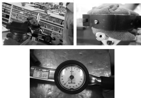
图 13 新件接管嘴 X-6 拧断现场操作图
