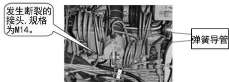
图3 座舱盖操纵作动筒机上安装状态图
