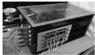
图1 喷雾冷却技术原理样机
