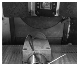
图 2 绿碳化硅滚轮修整金刚石砂轮
